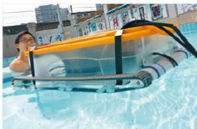
視野創新科技有限公司研發中的水底清潔機械人。
