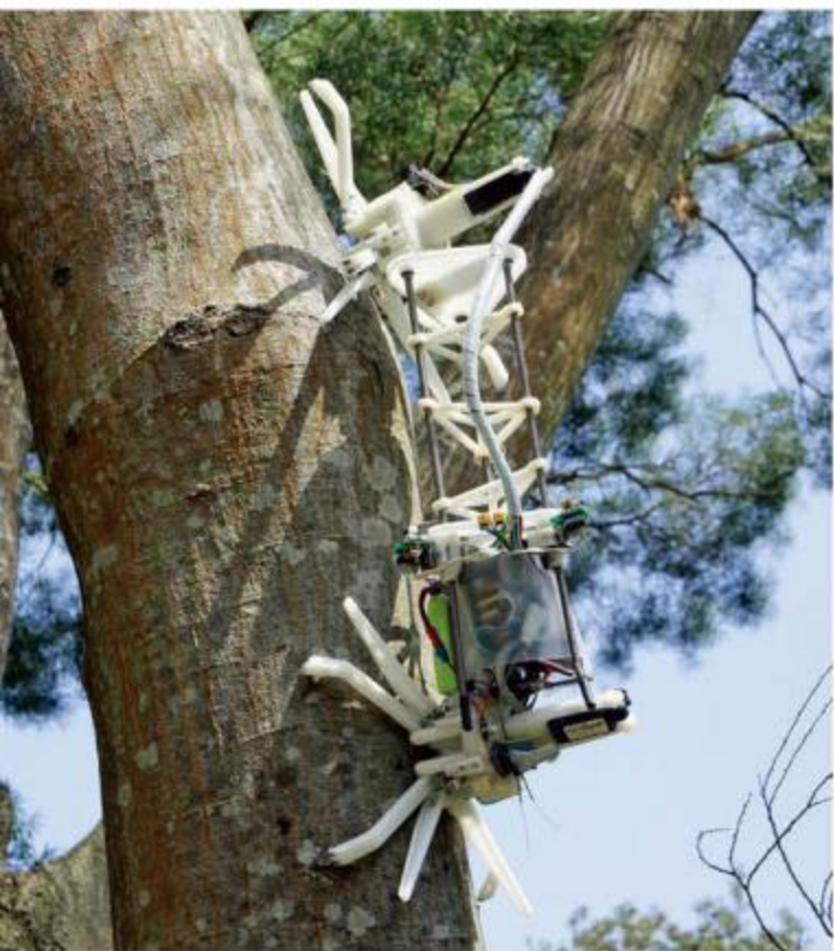
爬樹機械人的機械爪設計概念，獲美國太空總署參考使用。
